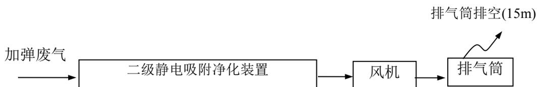
图 5.2-3 本项目加弹废气处理工艺流程图
